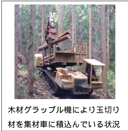
木材グラップル機により玉切り材を集材車に積込んでいる状況
